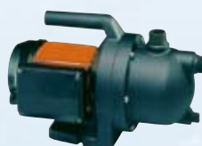
Bomba Garden Jet 700 Bomba autoaspirante Potencia de 0,7 KW, altura máx. 40 m, presión máx. 4,0 bar, caudal máx. 3000 l/h, altura máx. de aspiración 8 m, largada máx. de aspiración 15 m. Código 354012
